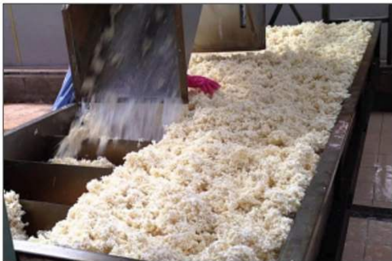
Figura 3. Látex natural aquecido e convertido em pedaços duros de borracha natural.
