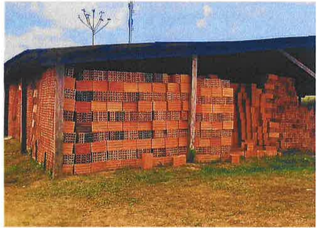
Figura 10 – Armazenamento em área coberta
